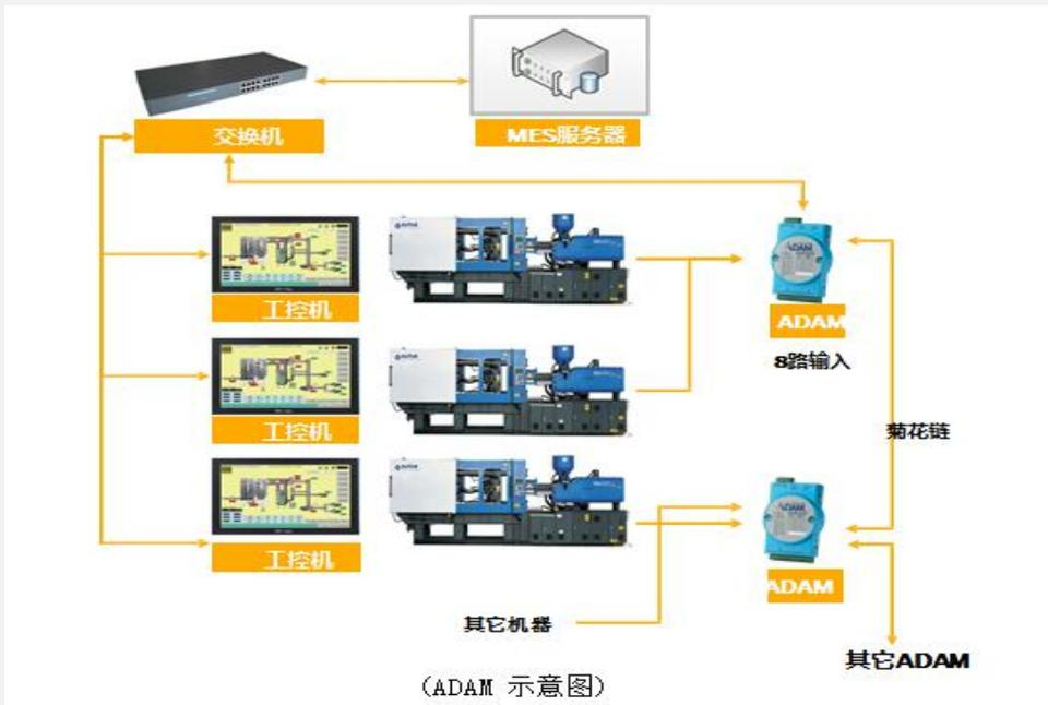
最高效的方式将不同品牌、不同通讯协议设备的状态参数信息组网，并将数据传送至系统后台进一步分析、实现远程监看控制。
