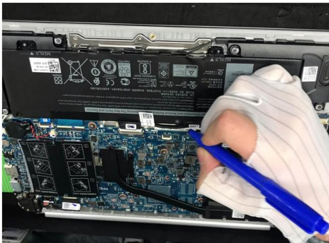
在组装前，62个检测点，手工的一个个检测。
