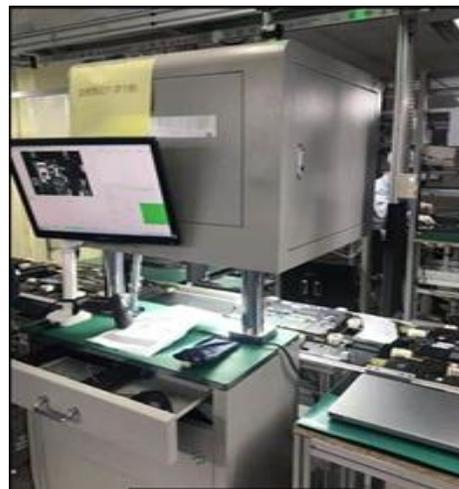
配上光学设备+AI算法，自动检测
