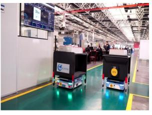
**效果目标**:实现准备物料→AGV车→加工设备工位的替人化自动配送。
