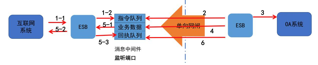
1. 互联网系统需要获取内网0A数据时,调用 注册在ESB上的服务A,将消息放入消息中间件的指令队列。 指令消息包括请求方url、请求ID,请求头,请求体等。
