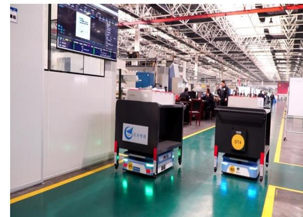
**效果目标：**实现准备物料→AGV车→加工设备工位的替人化自动配送。
